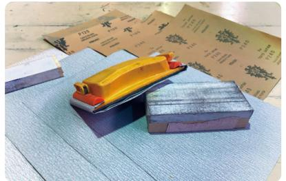
シミなどを消したい時には汚れた部分をサンディングします。汚れが取れたら、綺麗なウェスで塗料を塗ります。塗装後の拭き取りも忘れずに。
